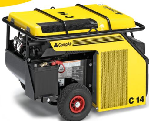
La gamma C10-12 - C14 è un'efficace alternativa agli utensili elettrici. Piccoli, compatti e leggeri: solo 150 kg con 1,0-1,4 m<sup>3</sup>/min. a 7-12 bar. Perfetti per un'ampia gamma di lavori di riparazione e installazione.
